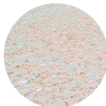
Paroi béton agrégats calcaire bouchardé
